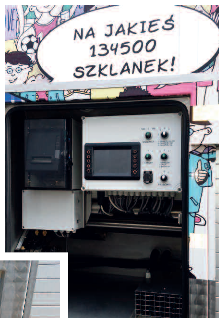
Fragment wyposażenia autocysterny: system do automatycznego poboru próbek oraz sterujący całością nowoczesny komputer PRO-WAM PK-4
