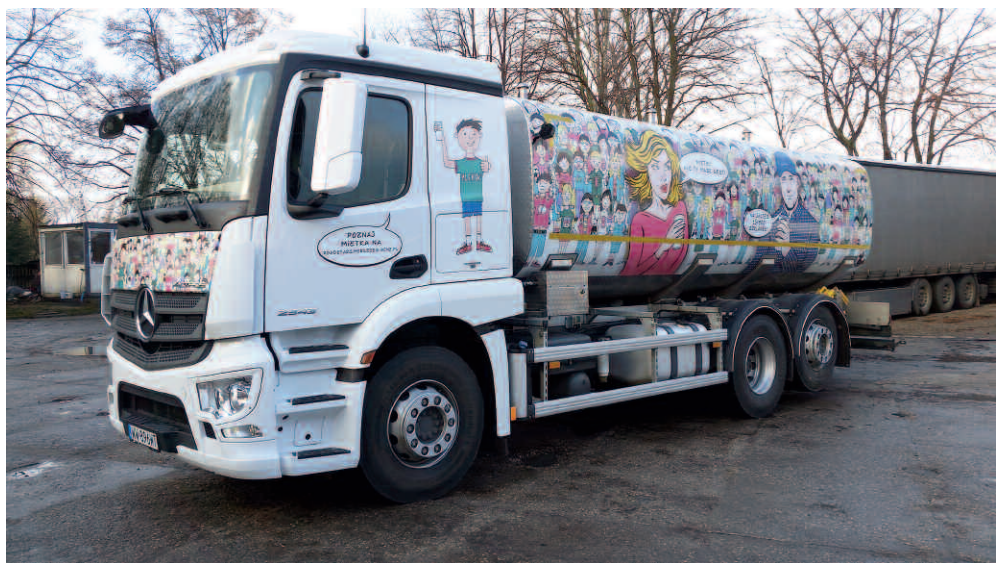
Bohater testu: Mercedes-Benz Actros 2543 6×2 z autocysterną na mleko firmy PRO-WAM
