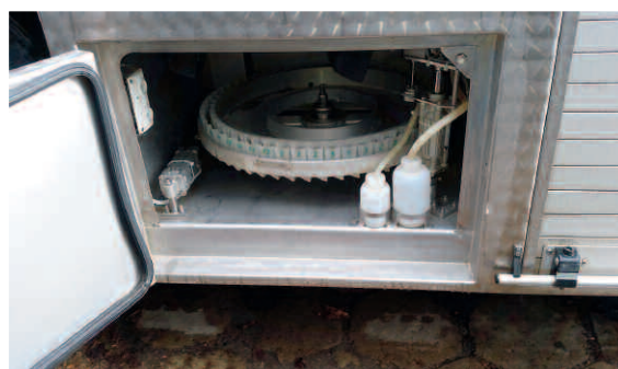
Fragment wyposażenia autocysterny: system do automatycznego poboru próbek oraz sterujący całością nowoczesny komputer PRO-WAM PK-4
